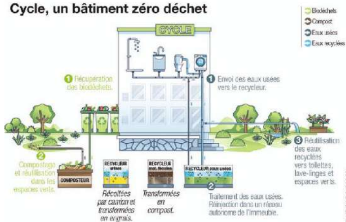
Principe de récupération des eaux de pluie et des eaux grises
