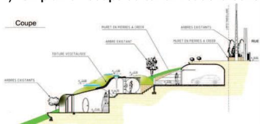
Le plan en coupe complète le plan de masse et permet de comprendre l'implantation du projet et ses incidences sur le terrain existant avant le projet
