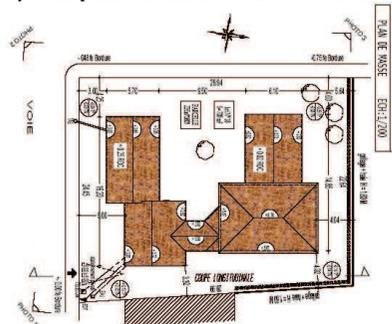
Il présente le projet dans sa totalité. Il permet de vérifier que les futures constructions respectent les différentes règles d'implantation et de hauteur, y compris par rapport aux constructions existantes, s'il y en a. Il permet également de connaître le projet d'aménagement du terrain, l'organisation des accès à la voie publique et des branchements sur les réseaux.
