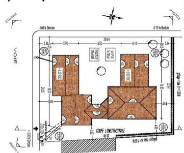
Il présente le projet dans sa totalité. Il permet de vérifier que les futures constructions respectent les différentes règles d'implantation et de hauteur, y compris par rapport aux constructions existantes, s'il y en a.
