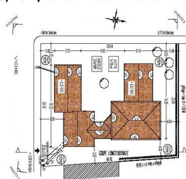
Il présente le projet dans sa totalité. Il permet de vérifier que les futures constructions respectent les différentes règles d'implantation et de hauteur, y compris par rapport aux constructions existantes, s'il y en a.
