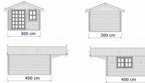
Le plan des façades et des toitures permet d'apprécier quel sera l'aspect extérieur de la construction.
