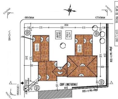
Il présente le projet dans sa totalité. Il permet de vérifier que les futures constructions respectent les différentes règles d'implantation et de hauteur, y compris par rapport aux constructions existantes, s'il y en a. Il permet également de connaître le projet d'aménagement du terrain, l'organisation des accès à la voie publique et des branchements sur les réseaux.
