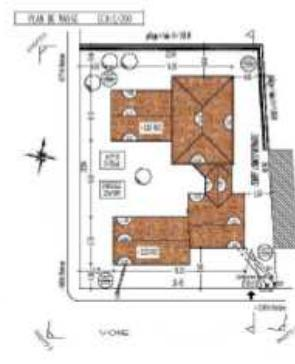
Il présente le projet dans sa totalité. Il permet de vérifier que les futures constructions respectent les différentes règles d'implantation et de hauteur, y compris par rapport aux constructions existantes, s'il y en a.
